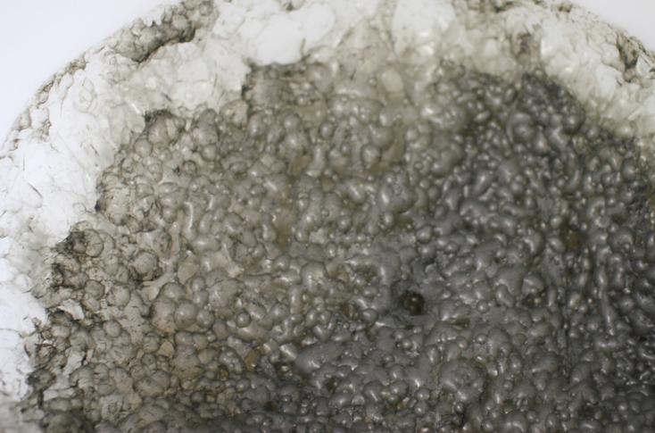
Abb. 1: Eine schnelle Abtrennung der Kohle durch Flotation ist erforderlich.
