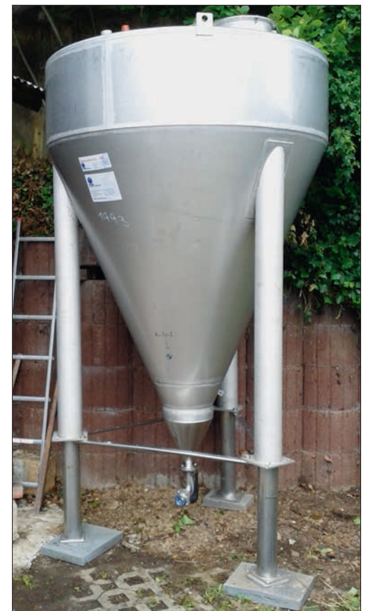
Zylindrokonischer Tank zur Mostvorklärung per Sedimentation. Foto: Börker
