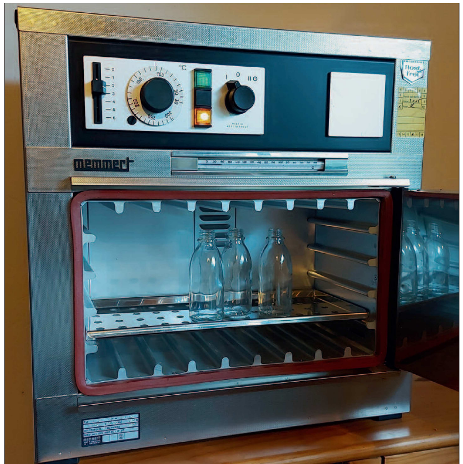
Ein Wärmeschrank mit präziser Temperatureinstellung ist ein nützliches Instrument zur Durchführung beschleunigter Alterungstests. Foto: V. Schneider
