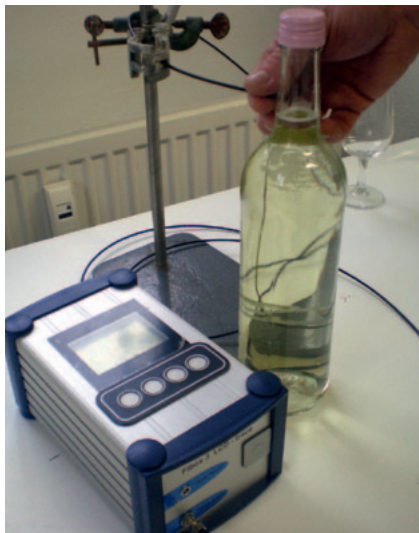
Abb. 3: Für die Lumineszenzmessung zur Ermittlung des Sauerstoffgehalts in verschlossenen Flaschen werden sauerstoffsensitive Sensoren in das Innere der Flaschen geklebt
